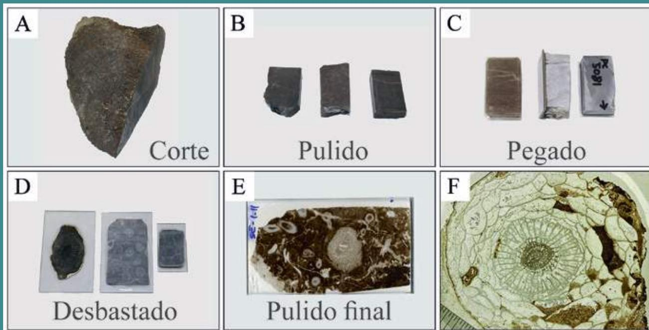
Realización de láminas delgadas. A) Se corta la roca que contiene los corales a estudiar con un disco de diamante. B) Se recortan en poliedros y se pule la cara que nos interesa. C) Se pega esta cara a un cristal delgado. D) Se desbasta la roca con una cortadora, eliminando el sobrante y dejando solo unas pocas micras de grosor. E) Se pule otra vez hasta que se observa perfectamente lo que se quiere estudiar. F) Imagen del coral al microscopio de luz transmitida.
